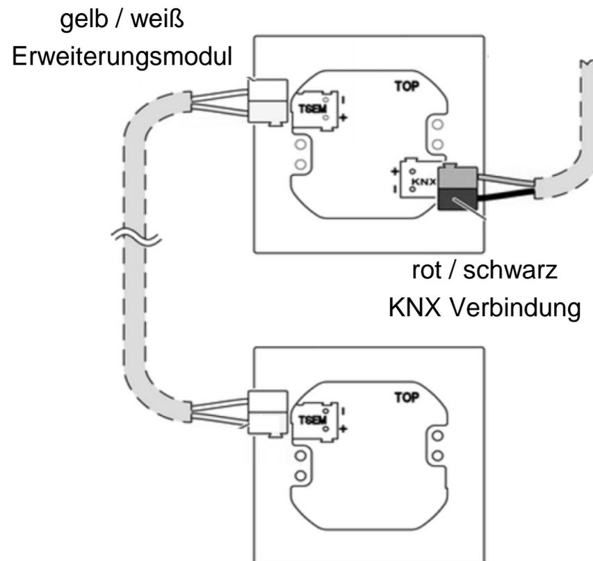
Maximal 30m zwischen Basis- und Erweiterungsmodul!!!
